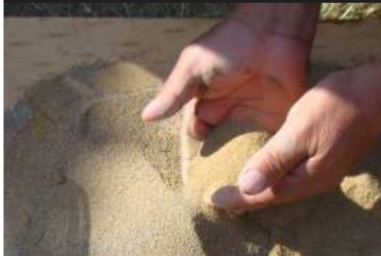
Obtención de tierra mejorada a través de la estabilización
