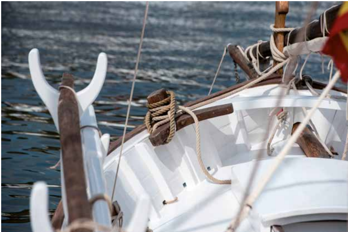
Detall de l'aparell de vela llatina (fotografia: David Arquimbau)
