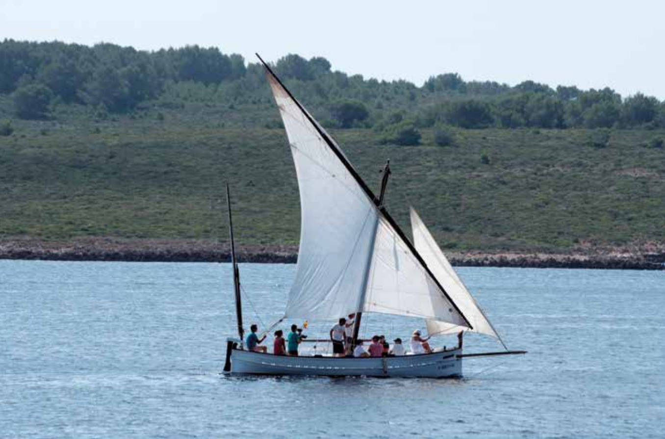
El llaüt Besitos equipat amb vela mestra amb martell i floc, amb pal en candela (fotografia: David Arquimbau)
