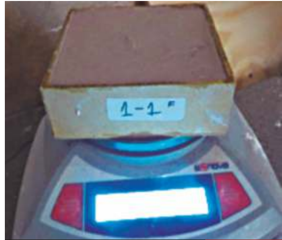
Primer pesaje del mortero
