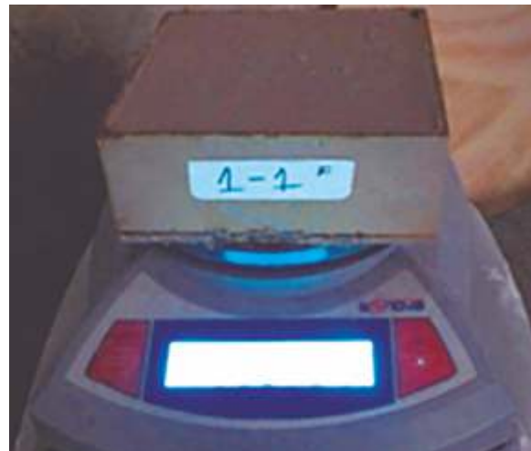
Pesaje entre secado
