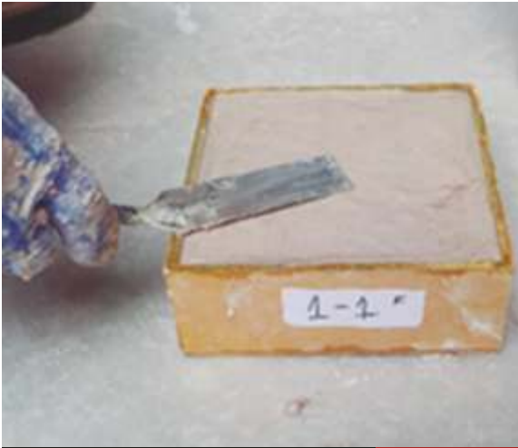
Mortero compactado en molde
