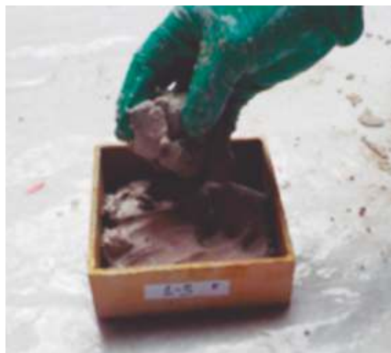
Vaciado del mortero en molde
